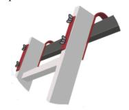
Прочно закрепляйте за конструкции или провода подвесные лестницы
