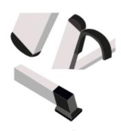
Снабжайте приставные лестницы и стремянки устройством, предотвращающим возможность сдвига и опрокидывания при работе
