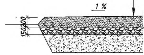
Конструкция тротуара из плитки
