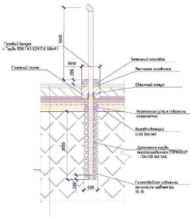
Рисунок 5.2.2.1 – Конструкция газоотводной скважины
