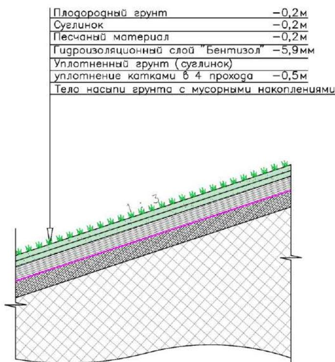
В процессе стабилизации свалочного грунта возможны локальные просадки тела свалки.
